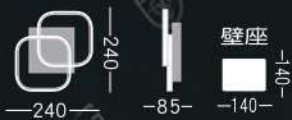
YS-339-1 12,000 高 240mm 寬 240mm 深 85mm LED 12W 3000K 鋁+壓克力 壁座 140×140mm
