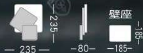
YS-342-1 12,000 高 235mm 寬 235mm 深 80mm LED 15W 3000K 鋁+壓克力 壁座 185×185mm
