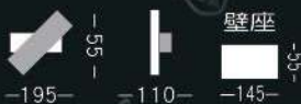
YS-336-3 10,000 高 55mm 寬 195mm 深 110mm LED 5W 3000K 鋁材 (燈具可轉動) 壁座 55x145mm
