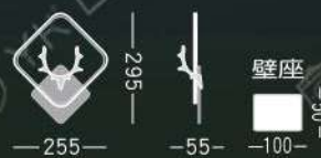
YS-335-4 12,000 高 295mm 寬 255mm 深 55mm LED 15W 3000K 鋁+壓克力 壁座 50x100mm
