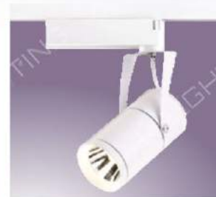
GN 85147 ( 12500 ) 長150mm 寬78mm 高240mm 附CREE COB LED 25w 3000K/4000K、鋁材加工成型 粉體烤漆、6063鋁材實心棒料、(另有黑)
