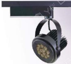
GN 85142 ( 20000 ) 長110mm 寬140mm 高220mm 附OSRAM LED 3wx12珠、防眩光蜂巢網 3000K/4000K/5700K、鋁材加工成型 粉體烤漆、鳍片型散熱器、(另有白)
