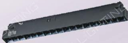
GN 8520F ( 12000 ) 長300mm 寬22mm 高25mm 附OSRAM 3030x18珠 18w、光通量1980lm 光學角度25°、鋁材、粉體烤漆
