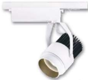
GN 85141 ( 21300 ) 長130mm 寬95mm 高185mm 附OSRAM LED 3wx12珠 3000K/4000K/5700K、鋁材加工成型 粉體烤漆、鳍片型散熱器、(另有黑)
