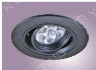
GN 85279 (11400) 寬108mm 高65mm 附歐司朗晶片 LED 10w 3000K/4000K/5700K、防潮PC框黑色 鱗片式散熱、可調照射角度 台灣製造 原壁切開關、即可4段調光
