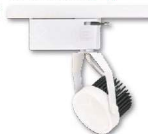
GN 8514K ( 7500 ) 長90mm 寬80mm 高170mm 附OSRAM LED 3030x12珠 3000K/4000K/5700K、鋁材加工成型 粉體烤漆、擴散板、1070冷銀壓散熱器 散光型
