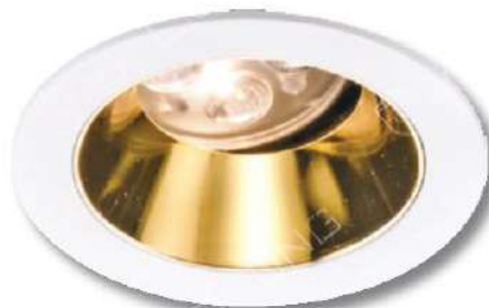
LD-30474 嵌孔 60mm 光源 OSRAM 3030x6珠 材質 鋁材、粉體烤漆、陽極處理 (富豪金) 尺寸 W68 H95mm
