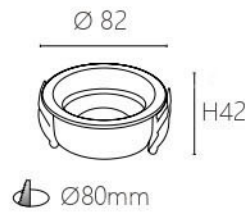
JBR 20802 材質：鋁材 尺寸：Ø82 H42 mm 嵌入孔：Ø80 mm (可適用 MR16)
