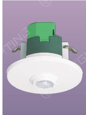
WTKF2401 (白色) 埋入式熱感自動開關 (天花板用) (主機) (附照度感應器) (延遲熄燈時間約10秒~30分鐘， 可調整型) 3A 110V AC
