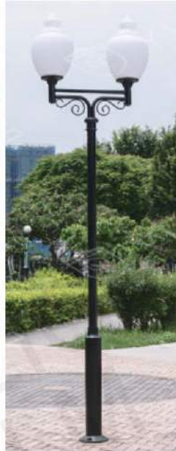
GLM-16468 55600 W1120mm H3800mm E27 LED 30wx2 另計 鋁鑄底座+鐵製燈架 乳白16"PE塑膠耐撞燈罩 管徑Ø76mm凹凸鋁合金管 台灣製造
