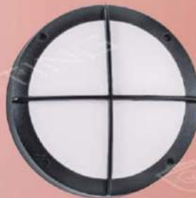
GLM-16643 4000 W220mm H220mm D80mm E27 LED 8wx1 另計 鋅合金壓鑄品、乳白PC耐撞燈罩 附不鏽鋼螺絲
