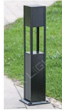
LV-11-5364 18250 □155mm H910mm E27 LED 13WX1 另計 鋁鑄品、5mm強化透明玻璃 向下照射、台灣製造
