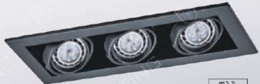
LV-11-5213 3450 L330mm W135mm H80mm 附歐司朗晶片 4珠 6WX3 3000K 4000K 6000K 金屬、另有白色
