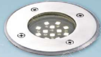
LV-11-5233 2800 W104mm H40mm 附LED 12顆 3WX1、暖白光、全電壓 304不鏽鋼面板、預埋盒自購 嵌入孔：Ø94mm H45mm
