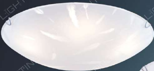
LV-11-2934 5500 W500mm H130mm 內附LED 72W 三色跳段、磁吸模組 金屬烤漆、玻璃
