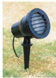
LV-11-560D 9000 L218mm W170mm H450mm E27 LED PAR38 17WX1 另計 鋁鑄品、5mm強化玻璃 防水矽膠圈、插柱長H230mm 台灣製造
