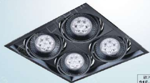
LV-11-524C 8360 L335mm W335mm H60mm 附美國LED普瑞 40W亮度、流明4200lm 發光角度:30度、電壓:AC110V~220V 消耗功率:28W 鋁材、PC、台灣設計&組裝
