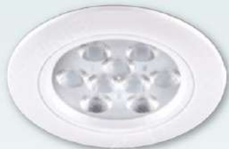
LV-11-5184 2200 W108mm H60mm 附歐司朗晶片 LED 12WX1 全電壓 黃光 白光 自然光 防潮PC框白色、鱗片式散熱 台灣製造
