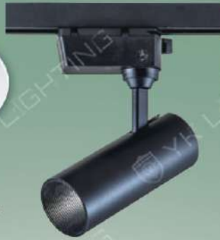
LV-11-5272 1650 W50mm H130mm 附美國LED普瑞 15W亮度、流明1440lm 發光角度:25度、電壓:AC110V~220V 消耗功率:12W 鋁材、PC、 台灣設計&組裝
