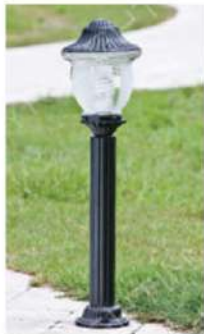
LV-11-5356 13250 W260mm H900mm E27 LED 16WX1 另計 鋁鑄品、玻璃燈罩 管徑Ø76mm凹凸鋁合金管 台灣製造
