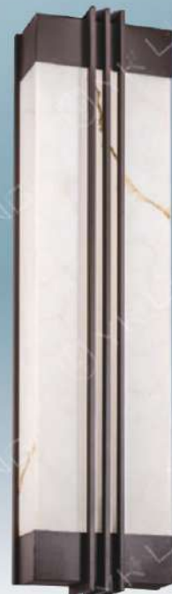
LV-11-537A 54500 W300mm H1200mm D150mm 附T8 LED (全套)3尺X2 全套304不鏽鋼製品、防水 粉體烤漆咖啡紅、仿雲石燈罩 台灣製造
