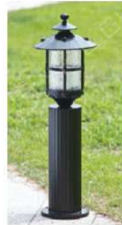
LV-11-5358 18000 W260mm H840mm E27 LED 16WX1 另計 鋁鑄品、裂紋PS塑膠燈罩 管徑Ø140mm凹凸鋁合金管 台灣製造
