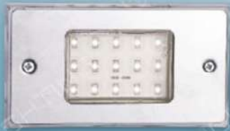
LV-11-5237 2000 W128mm H70mm D42mm 附LED 18顆 2.5WX1、暖白光、全電壓 304不鏽鋼面板、壓克力成型、預埋盒自購 嵌入孔：W95mm H55mm D42mm
