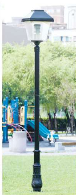
LV-11-5285 68500 W490mm H3500mm E27 LED 30WX1 另計 或LED 50WX1 另計(防眩罩去掉) 燈具上蓋為強化玻璃纖維一體成型 燈罩為透明PC塑膠耐撞燈罩 管徑Ø89mm凹凸鋁合金管 鋁鑄品整組、台灣製造
