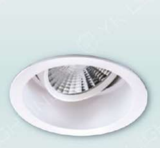
LV-11-525C 2360 W112mm H65mm 附美國LED普瑞 12W亮度、流明1200lm 發光角度:20度、電壓:AC110V~220V 消耗功率:9W 鋁材、PC
