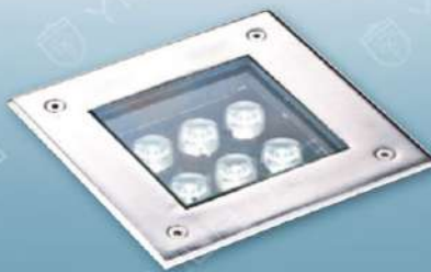
LV-11-5238 5900 □150mm H75mm 附LED 1WX6、暖白光、全電壓 304不鏽鋼面板、鍍化玻璃、附預埋盒 嵌入孔：□130mm H75mm
