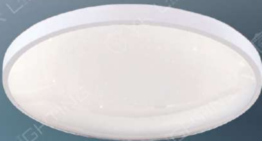
LV-11-2554 6500 W500mm H70mm 附LED 72W 可分黃光/白光/自然光/小夜燈共四段 附遙控器、可調光、調色 金屬、壓克力
