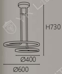
OK 21931 72000 Ø400+Ø600 H730mm 內含LED 45W 4000K 鋼材烤漆 壓克力
