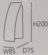
OK 20073/4 17500 W85 H200 D75mm 內附LED 6W 3000K 鋁材烤漆
