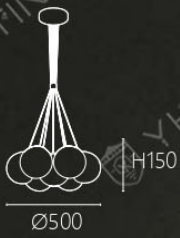
OK 21431 62000 Ø500 H150mm 線長1000mm 附LED 8W x 7 3000K 鋼材 玻璃
