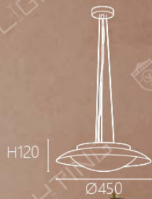
OK 21661/2 52000 Ø450 H120mm 線長1000mm 內含LED 36W 3000K 鋼材烤漆 玻璃
