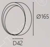
OK 20071/2 18000 Ø165 D42mm 內附LED 6W 3000K 鋁材烤漆
