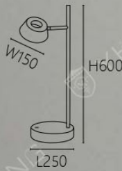
OK 20522 40000 W150 L250 H600mm 線長1500mm 附LED 8W x 1 3000K 鋼材 附開關
